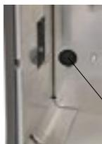
Le fusible est de 10 AF (à fusion rapide). En cas de fusion, retirer la tête du support de fusible en exerçant une pression et une rotation de 30 degrés dans le sens inverse des aiguilles d'une montre. Si la destruction se produit à nouveau, vérifier la valeur du fusible (10 AF), si cette dernière est correcte, vous devez faire vérifier ce matériel par un service technique Elinchrom.
