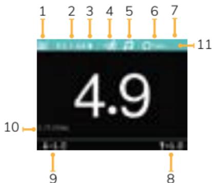
1. Sincronizzazione Skyport n-Normal, s-Speed. Per una migliore compatibilità e un intervallo di distanza massimo, utilizzare sempre le modalità di sincronizzazione n-Normal.
