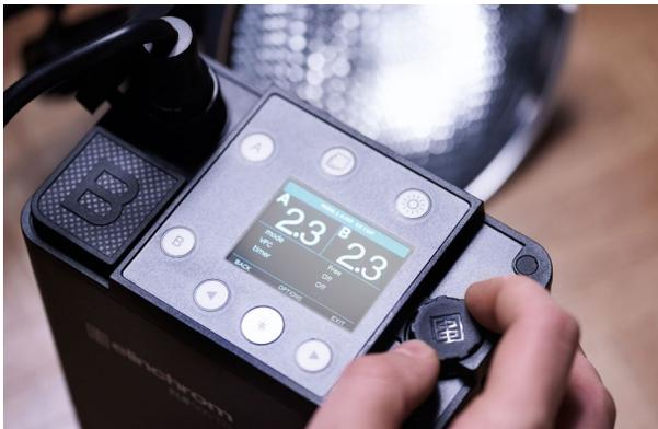
Los ajustes de la lámpara de modelado se modifican fácilmente en el menú ELB 500 TTL.
